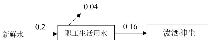
图 3-1 项目水量平衡图
